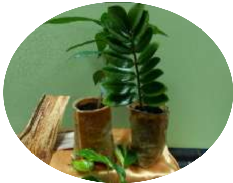
ถุงห่อรากพืชชีวภาพเสริมใยเซลลูโลสด้วยกากกล้วยและยางพารา
