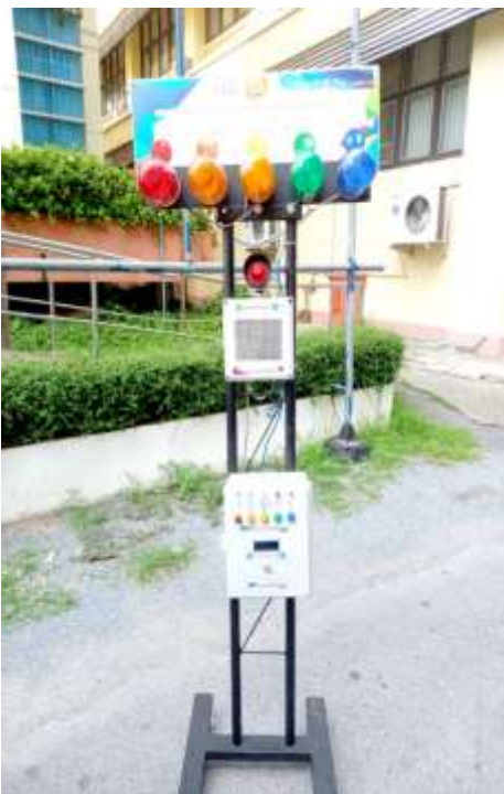
เครื่องตรวจวัดและแจ้งเตือนปริมาณฝุ่นละอองในอากาศที่สร้างเสริมในการป้องกันผลกระทบต่อสุขภาพประชาชน
